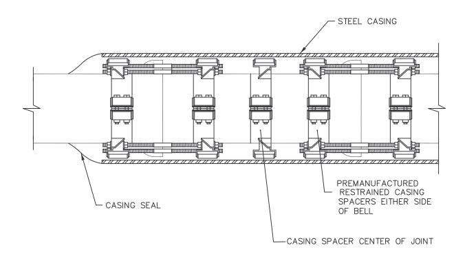
STANDARD PIPE CASING / RESTRAINED JOINT
